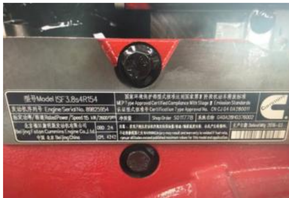
محل نصب پلاک مشخصات موتور
